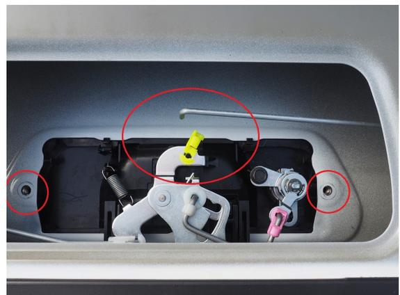
3) Befestigen Sie die Basisplatte mit Stellmotor unter Verwendung der beiden Muttern aus 2)
