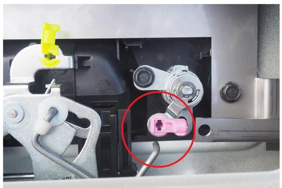
5) Legen Sie nun wie abgebildet das Schließgestänge mit dem Halter des Zylinders und des Stellmotors unter Verwendung des mitgelieferten Verbinders (gelb)
