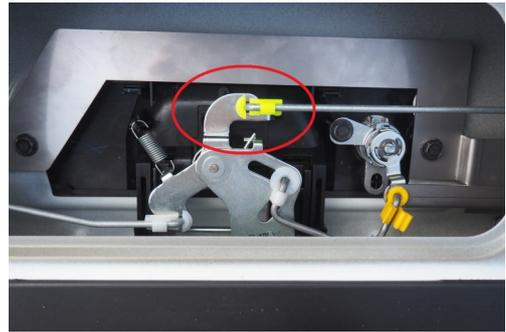
7) Verbinden Sie den Kabelbaum mit den Kabeln des Stellmotors:
